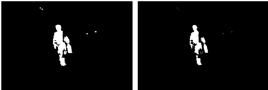
Figure 3 a) Image originale b) Image après érosion
