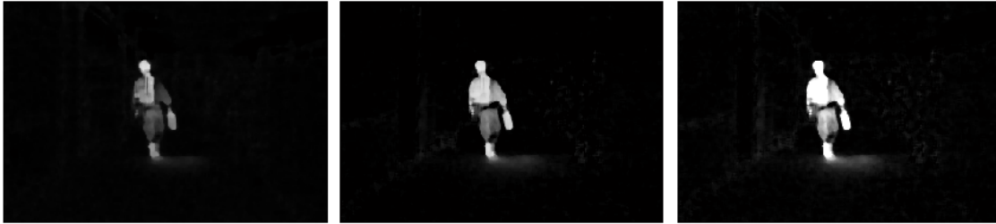
Figure 5 a) Algorithme de différence b) Algorithme de division c) Combinaison des algorithmes.
